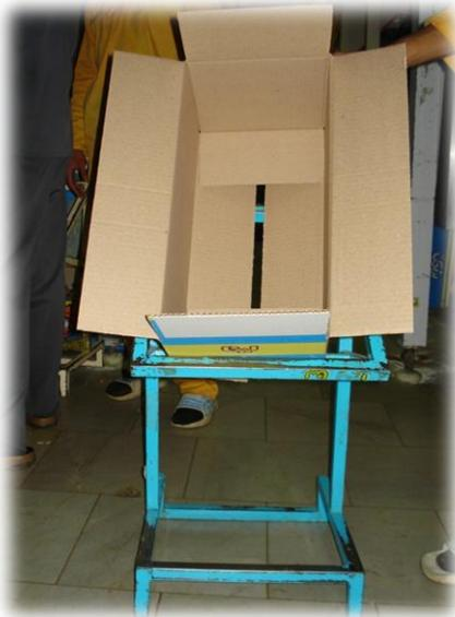
میز بسته بندی: با استفاده از این وسیله بصورتی که کارتن بسته بندی به صورت شیب دار روی آن قرار گرفته و پاهای کاربر داخل آن قرار میگیرد بسته بند قادر خواهد بود بدون هیچ گونه خم شدن و تغییر ناگهانی پوستچر در مدت بیشتری به کار خود ادامه داده و احساس خستگی زود رس نکند. بطوری که ابزار موجب شده کارتن بسته بندی در محدوده دسترسی قرار گیرد و همچنین باعث کمک به نحوه صحیح نشستن می کند و از طرفی برخلاف سایر روش های مشابه بسته بندی از خم شدن و جمع شدن پای پرسنل در حین بسته بندی جلوگیری می نماید.
