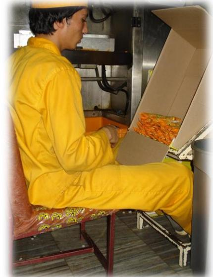
**صندلی با سطح نشیمن پایین:** همانطور که در تصویر مشاهده میشود کاربر بسته بند از صندلی با سطح نشیمن پایین استفاده میکند که موجب شده دستگاه بسته بند در محدوده دید وی قرار گیرد تا به کار تسلط بیشتر داشته و از فشارهای وارده به سیستم اسکلتی و عضلانی به خصوص در ناحیه گردن جلوگیری به عمل می آید.
