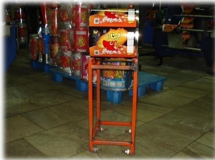
**کاری چرخ دار:** با ساخت و تهیه این وسیله حمل و جابه جایی محصول تا محل بارگیری و خروج از انبار محصول به کمک این وسیله صورت میگیرد. استفاده از این وسیله موجب بارگیری و جابه جایی آسان شده بدین صورت که از انباشت بار روی زمین که همراه با خم شدن هنگام گذاشتن و برداشتن بار میباشد و همچنین حمل دستی بار جلوگیری به عمل می آورد .
