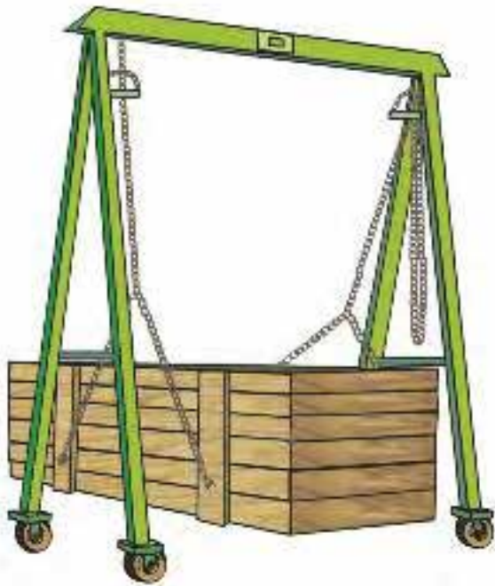
شکل ۹-۱: جرثقیل متحرک برای حمل بار سنگین وزن در مسافت کوتاه با حداقل ارتفاع، وسیله ای قابل اطمینان، ایمن و عملکرد آسانی نیز دارد.
