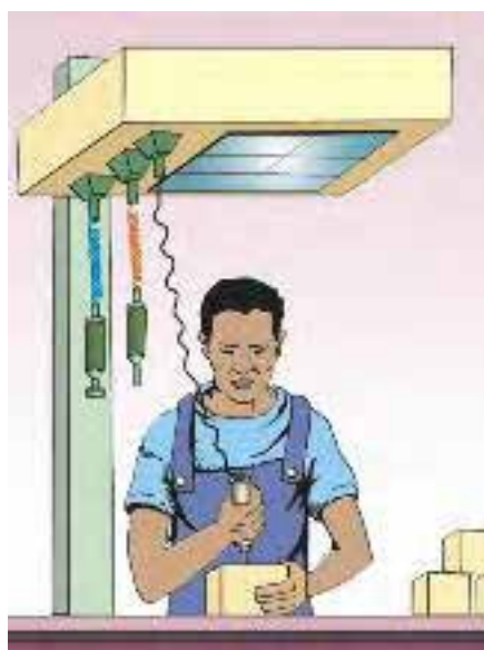
شکل ۲۰-۳: چهار چوب مخصوص بالای سر با مکانیسم فنری برای ابزارهای آویزان نصب کنید.
