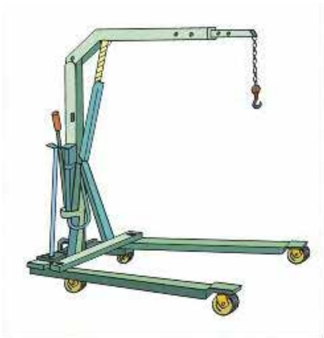
شکل ۹-۳: جرثقیل زمینی هیدرولیکی دستی با یک بازوی متحرک تلسکوپی
