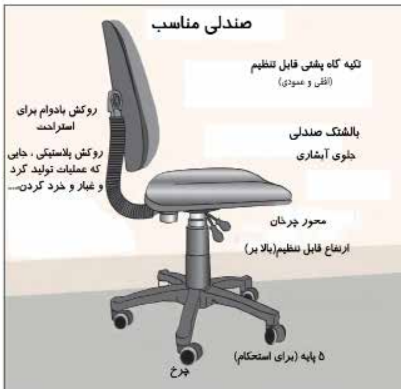
شکل ۳-۵۹: برای کارگران نشسته، صندلی قابل تنظیم مناسب همراه با تکیه گاه فراهم کنید.
