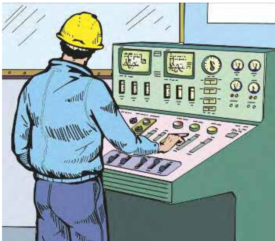
شکل ۳۹-۱: مهم‌ترین نمایشگرها و علائم را در زاویه دید ۵۰-۲۰ درجه زیر خط افقی چشم اپراتور در حالت ایستاده یا نشسته نصب کنید.
