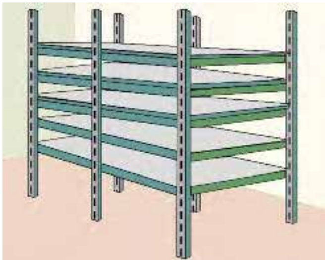
شکل ۸-۱: قفسه نگهداری افقی چند طبقه برای صفحات فلزی یا تخته چند لایه. مراقب باشید همه چیز خشک باشد تا آب بین صفحات پخش نشود و به آنها آسیب نرساند.
