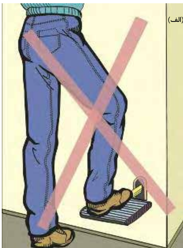
شکل ۳۸-۲: اهرم پایی که با بلند کردن پا از سطح زمین کار می‌کند، خسته کننده است (الف). سطح اهرم پایی را پایین تر بیاورید و یک زیر پایی برای عملکرد آسان اهرم فراهم کنید (ب).
