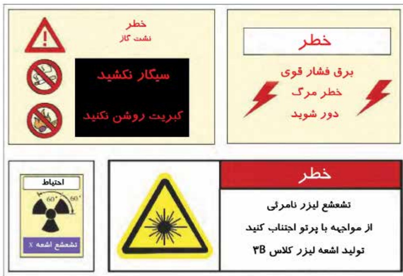
شکل ۴۳: علائم هشدار دهنده باید پیام‌هایی کوتاه داشته باشند که ماهیت خطر و شدت آن را نشان دهد، که چه کارهایی باید انجام داد و یا انجام نداد.
