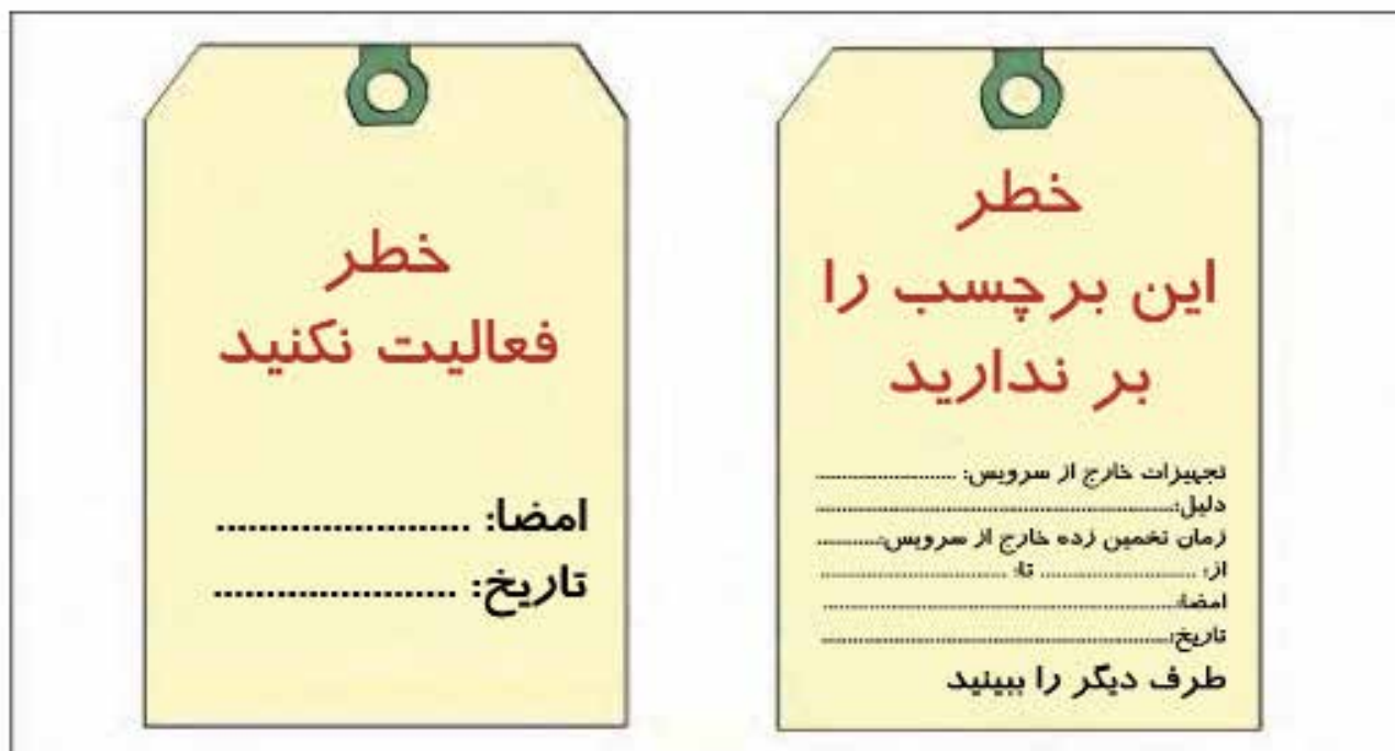
شکل ۵۰-۱: پشت و روی نمونه برچسب استفاده شده برای تجهیزات، وقتی در حال تعمیر بوده و ناایمن می باشد.
