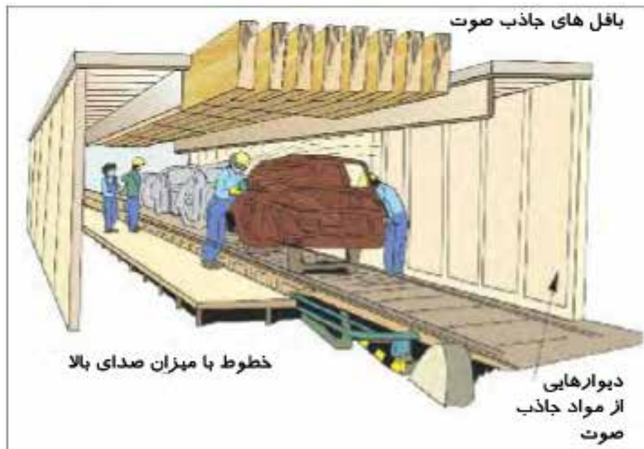
شکل ۸۵-۴: برای خطوط تولید پر سر و صدا، از دیوارهایی با مواد جاذب صوت و صفحه های جاذب استفاده کنید تا میزان صدا را کاهش دهد و به منظور پیشگیری از اثرات صدا نواحی مجاور را جدا سازی کنید.
