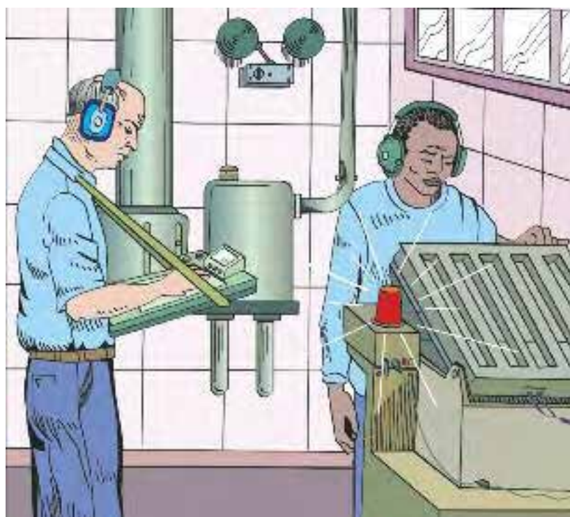
شکل ۸۷-۲: مطمئن شوید که محافظ های گوش موثرند و مانع ارتباطات ضروری نمی شوند. علائم و اخطارهای هشدار دهنده نوری زمان استفاده از حفاظ شنوایی ابزار مهم ارتباط هستند.
