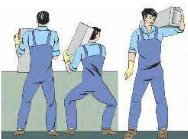
شکل ۱۵-۴: بلند کردن بارهای سنگین از روی یک سکو در جلوی بدن با استفاده از نیروهای پا انجام می گیرد. بلند کردن بار از روی سکو بهتر از بلند کردن از سطح زمین است.
