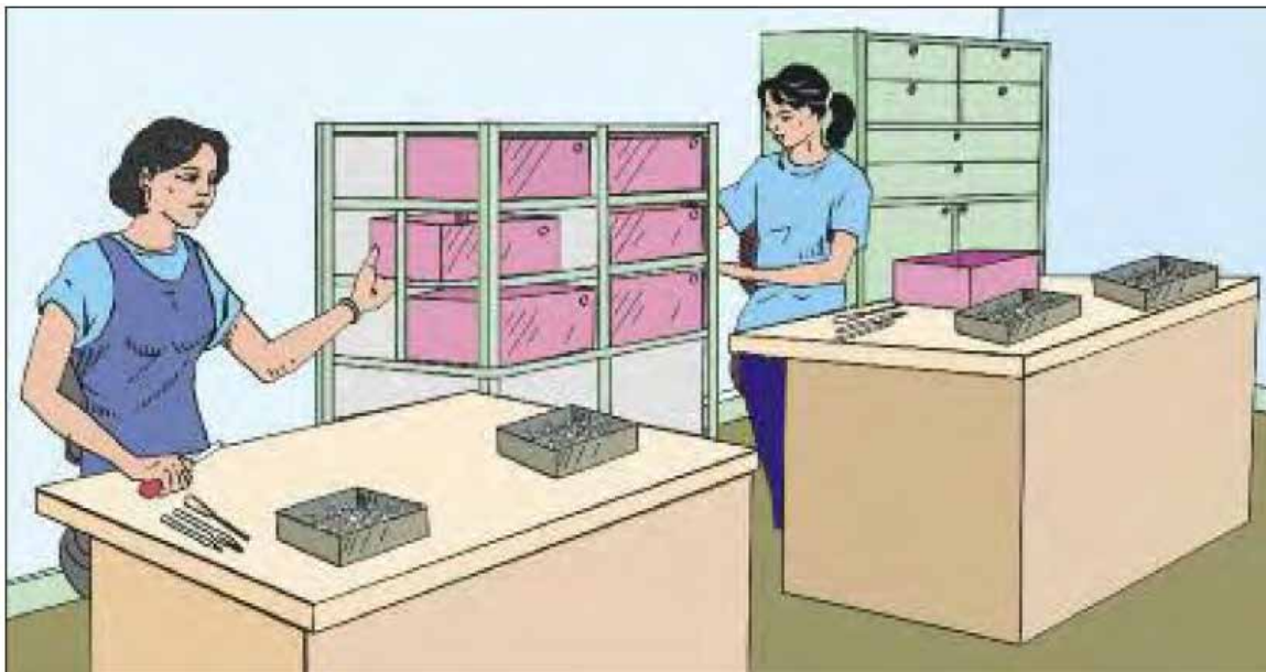
شکل ۵-۱: قفسه‌ها یا طبق‌های آماده فراهم کنید، بنابراین آیتم‌های کاری به طور مستقیم از یک ایستگاه به ایستگاه بعدی می‌روند.
