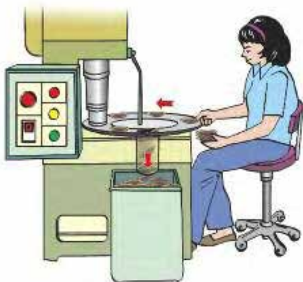
شکل ۴۶-۱: دستگاه پرس با تغذیه گردونه ای
