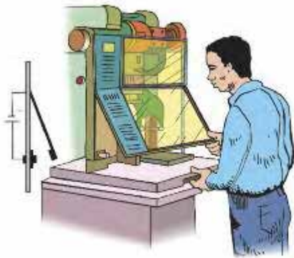
شکل ۴۸-۲: حفاظ اینترلاک با وسیله قطع کننده
