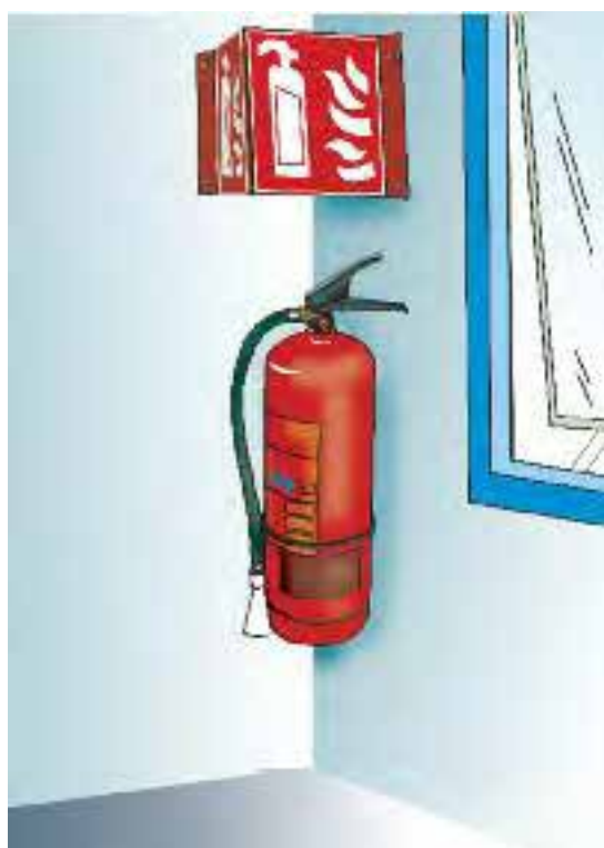
شکل ۸۱-۱: به تعداد کافی از خاموش کننده های حریق برای مکان های مشخص شده نواحی کار فراهم کنید.
