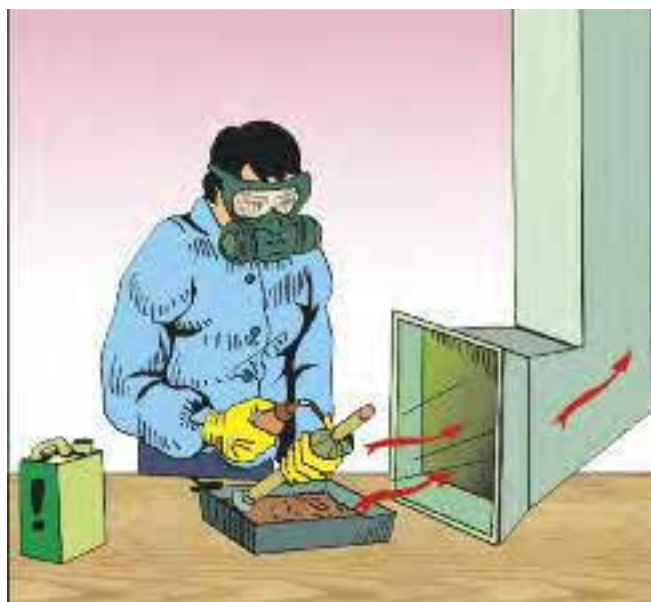
شکل ۹۲-۱: فیوم های سمی می توانند با سیستم تهویه موضعی خارج شوند، تا از مواجهه کارگر با مواد شیمیایی خطرناک پیشگیری شود.
