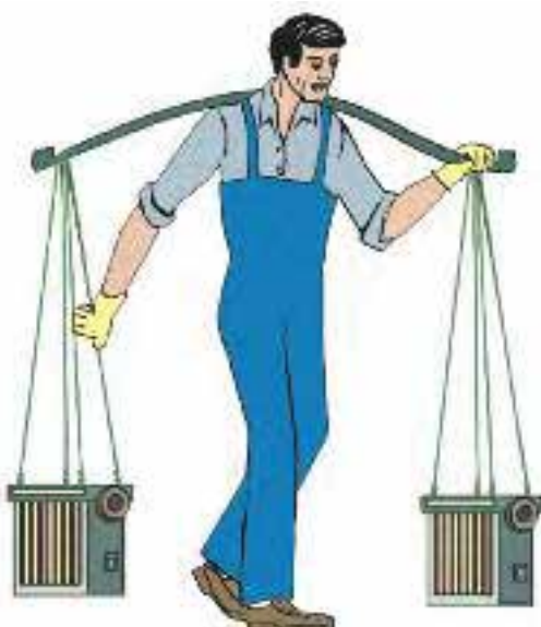
شکل ۱-۱۳: میله عریض یا وسیله مشابه شکل فوق برای حمل دو بار مجزا در بعضی فواصل، با حفظ تعادل و حداقل تعداد بلند کردن و پایین آوردن بار مفید است.
