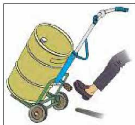
شکل ۶-۳: وسیله جابه جایی بشکه نه تنها کار را آسانتر می کند بلکه به جلوگیری از آسیب کمک می کند.
