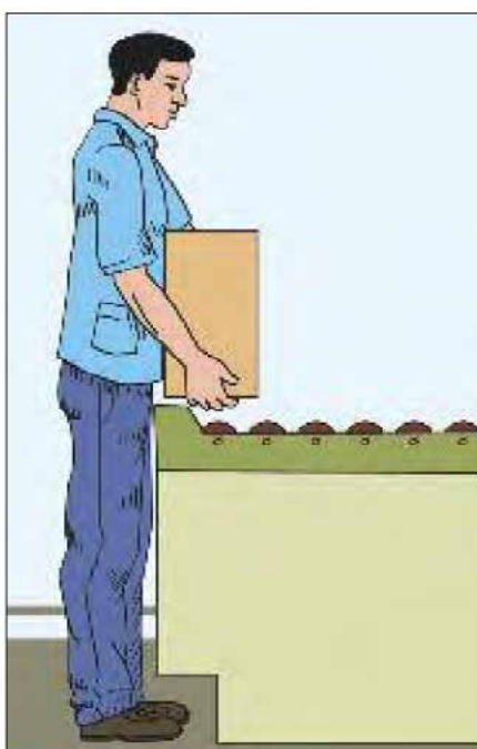
شکل ۵-۲: غلطک‌ها و نوارهای نقاله می‌توانند فاصله کالاهایی که بطور دستی جابه‌جا می‌شوند، را کاهش دهند. ارتفاع کار به گونه‌ای باشد که وقتی آیتم کاری با دست جابه‌جا می‌شود بدون خم شدن بالاتنه باشد. مطمئن شوید فضای کافی برای پا و بدن در نزدیکی غلطک یا نوار نقاله‌ها وجود دارد.
