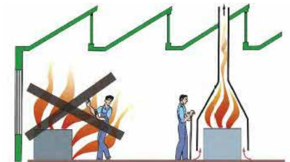
شکل ۷۳-۱: از هود موضعی برای گرمای تابشی و آلودگی استفاده کنید.
