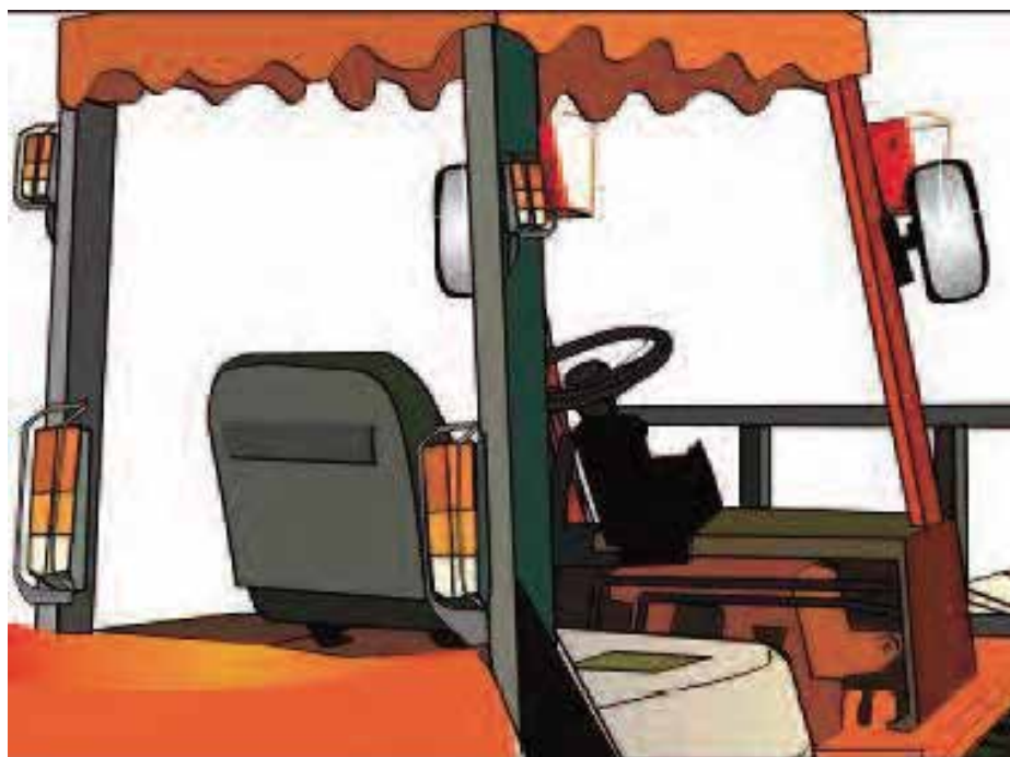
شکل ۶۳-۲: تنظیم مناسب وضعیت چراغ ها و آینه ها باعث دید وسیع در موقعیت های مختلف رانندگی می شود.
