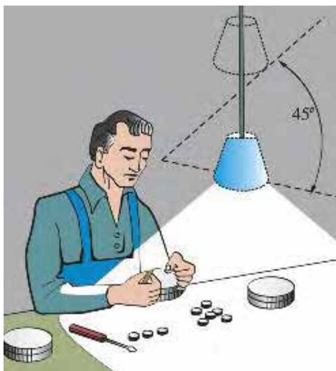
شکل ۱-۷۰: چراغ حباب دار باید در ارتفاع مناسب نصب شود.
