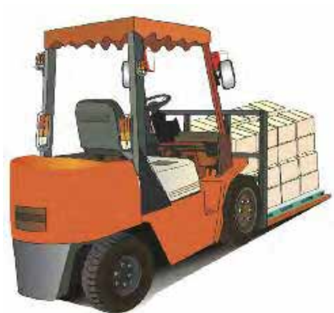
شکل ۴۹-۱: برای افزایش راحتی راننده لیفتراک صندلی جاذب ارتعاش، آینه‌ها، سقف و پالت‌های مناسب فراهم کنید.
