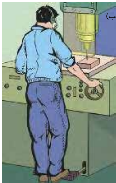
شکل ۳۸-۱: اهرم های پایی را در سطح زمین قرار دهید و برای عملکرد راحت به اندازه کافی بزرگ طراحی کنید (الف) و (ب).
