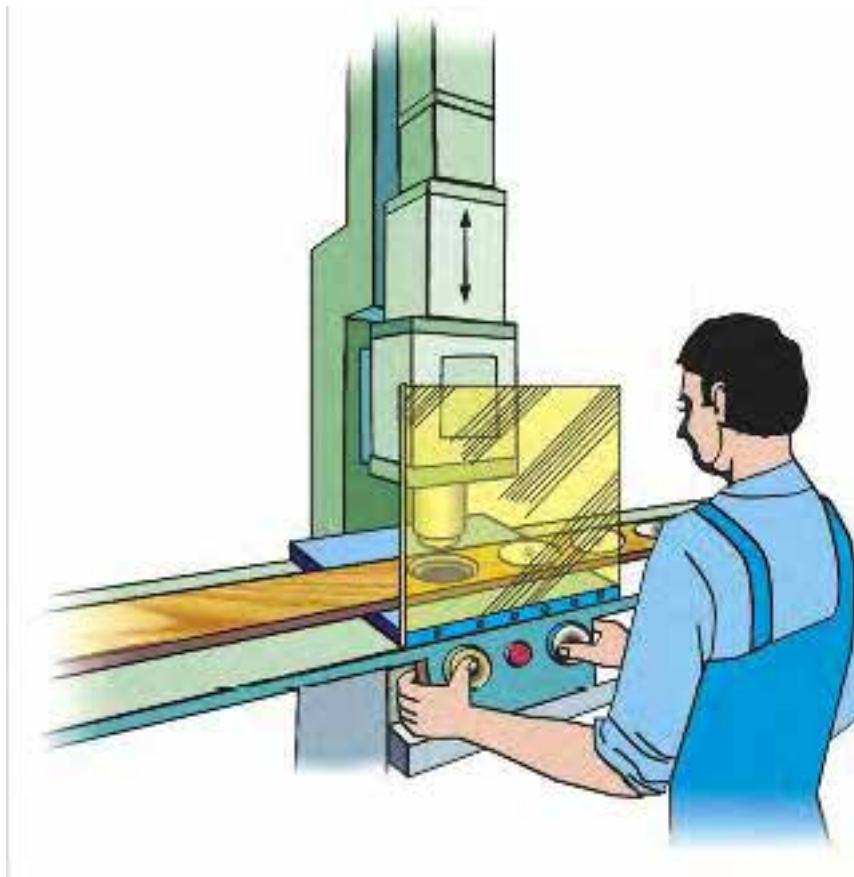
شکل ۴۸-۱: ماشین با کنترل دو شستی
