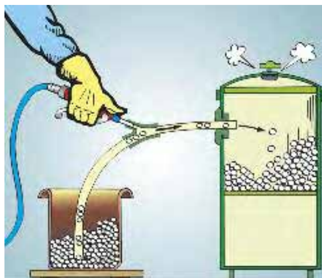
شکل ۴۵-۳: مواد نیمه جامد یا دانه ای می توانند با هوای فشرده جابه جا شوند.
