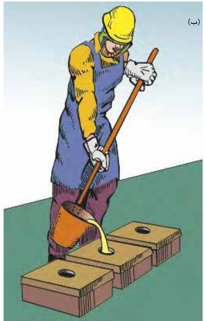
شکل ۲-۱۰۱: تطبیق وسایل حفاظت فردی با نوع آلاینده خطرناک در محل کار بسیار مهم است. استفاده درست و منظم آنها را بررسی کنید (الف) و (ب).
