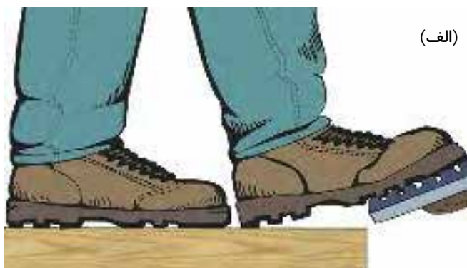
شکل ۳۸-۱: اهرم های پایی را در سطح زمین قرار دهید و برای عملکرد راحت به اندازه کافی بزرگ طراحی کنید (الف) و (ب).
