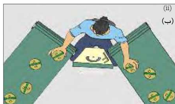
شکل ۵-۳: چیدمانی ایجاد کنید که به کارگر اجازه دهد در حالیکه وضعیت طبیعی بدن را حفظ می‌کند اشیاء را از یک نوار نقاله به بخش بعدی حرکت دهد. صفحه فلزی و نقاله انتقالی جابه‌جایی اشیاء را آسان‌تر می‌کند (الف) و (ب).
