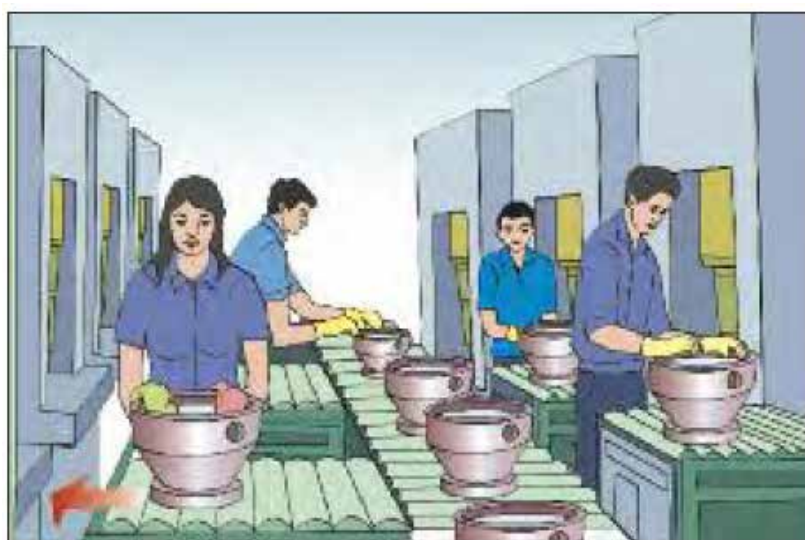
شکل ۶-۴: خط نوار نقاله غیرفعال برای حرکت ریخته گری موتورهای سنگین در ارتفاع کاری.
