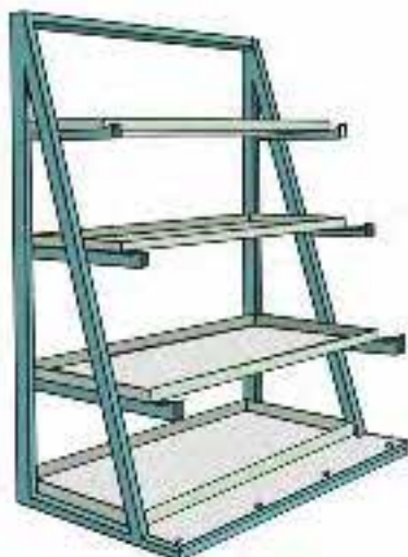
شکل ۸-۳: قفسه های عمودی، میله های فلزی و پروفایل مختلف می تواند در فضای محدود یا نزدیک محل کار نگهداری شود. قفسه های نوع سینی شکل، جای کافی برای قطعات کوچک را فراهم می کند.
