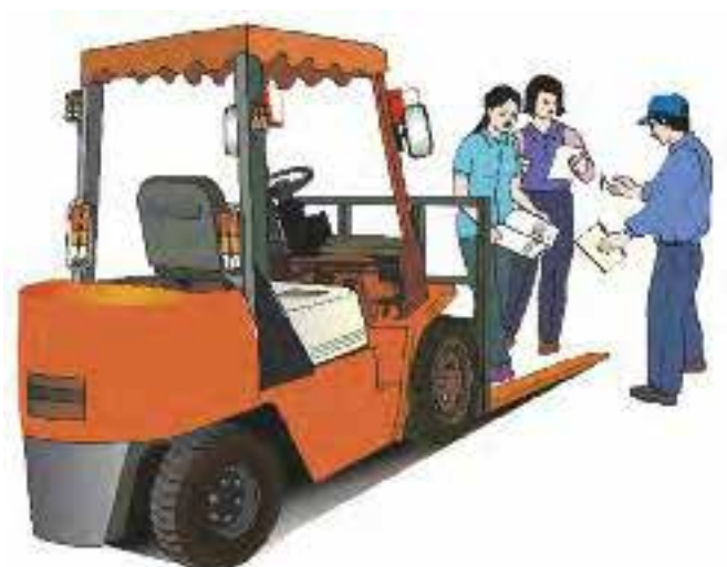
شکل ۴۹-۲: برای اطمینان از ایمنی لیفتراک‌ها و مسیرهای تردد، قبل از استفاده روزانه از چک لیست استفاده کنید.
