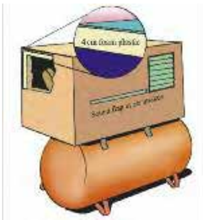
شکل ۸۵-۲: صفحه سخت ۱.۵ میلیمتری می تواند ارتعاش را کاهش دهد.
