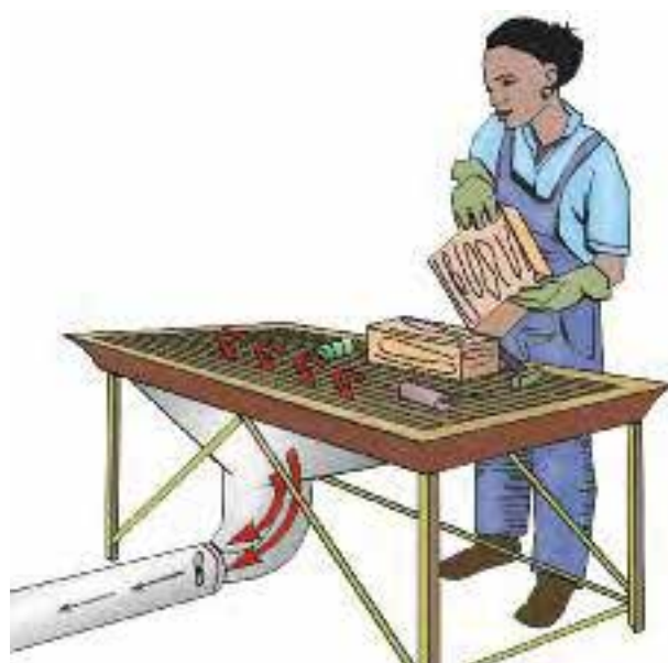
شکل ۹۲-۲: روش دیگر استفاده از تهویه موضعی با خروج آلاینده ها از میز کار قبل از رسیدن به منطقه تنفسی کارگر است.
